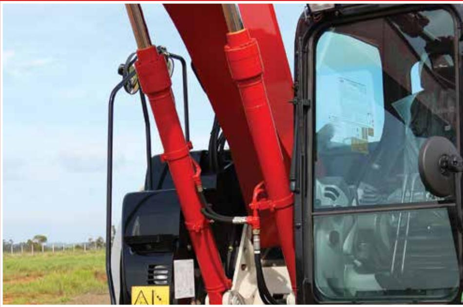
Resultado de um sistema hidráulico avançado, a 145X3E tem maior capacidade de escavação, maiores velocidades de giro e elevação simultâneas que proporcionam ciclos de trabalhos rápidos. O controle da válvula de centro aberto permite que o óleo hidráulico retorne ao tanque quando a válvula de controle está centralizada, o que proporciona uma sensação muito mais suave ao operar a máquina e elimina o excesso de pressão em todo o sistema. Isso também ajuda a economizar combustível.
