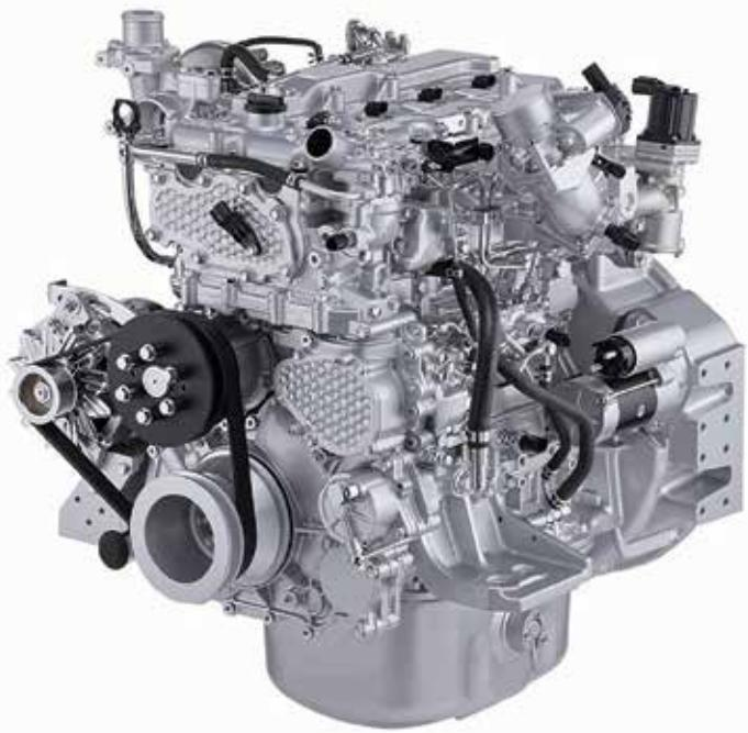
Com um motor especialmente desenvolvido para o modelo 145X3E, a nova série de escavadeiras Link-Belt apresenta uma versão mais robusta, mais eficiente e mais econômica do Isuzu 4JJ1X com certificação equivalente Tier 3 EPA. Um motor mais robusto, desenvolvido para as condições severas da América Latina e com sistema eletrônico de proteção.
